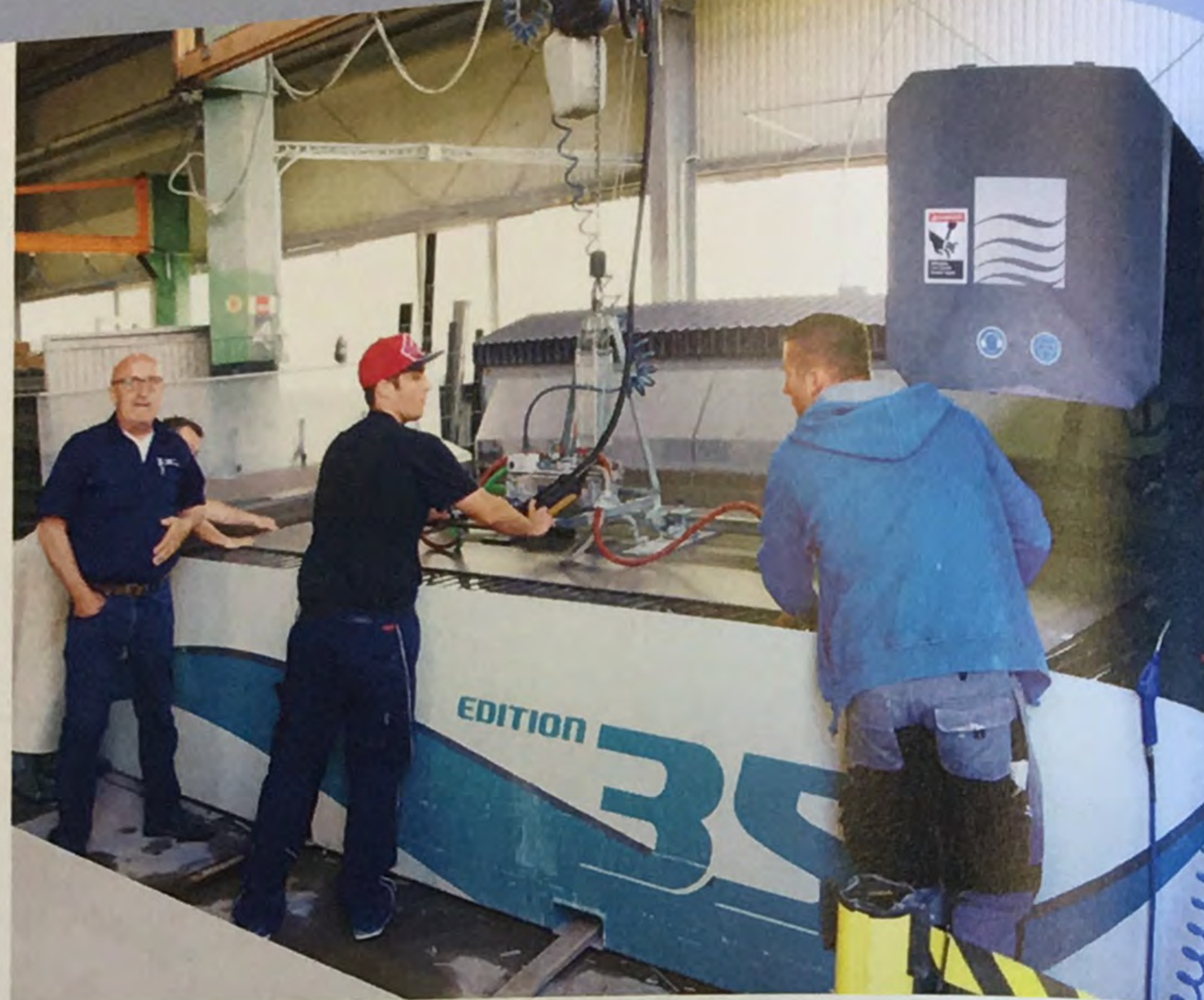
Küchenstudios als Kunden durch Maschineninvestition gewonnen: Dieter (links im Bild) und Günter Becker profitieren davon, mit ihrer Flow-Wasserstrahl-Anlage sämtliche Werkstoffe – hier eine sechs Millimeter dünne Neolith-Platte – exakt zuschneiden zu können
