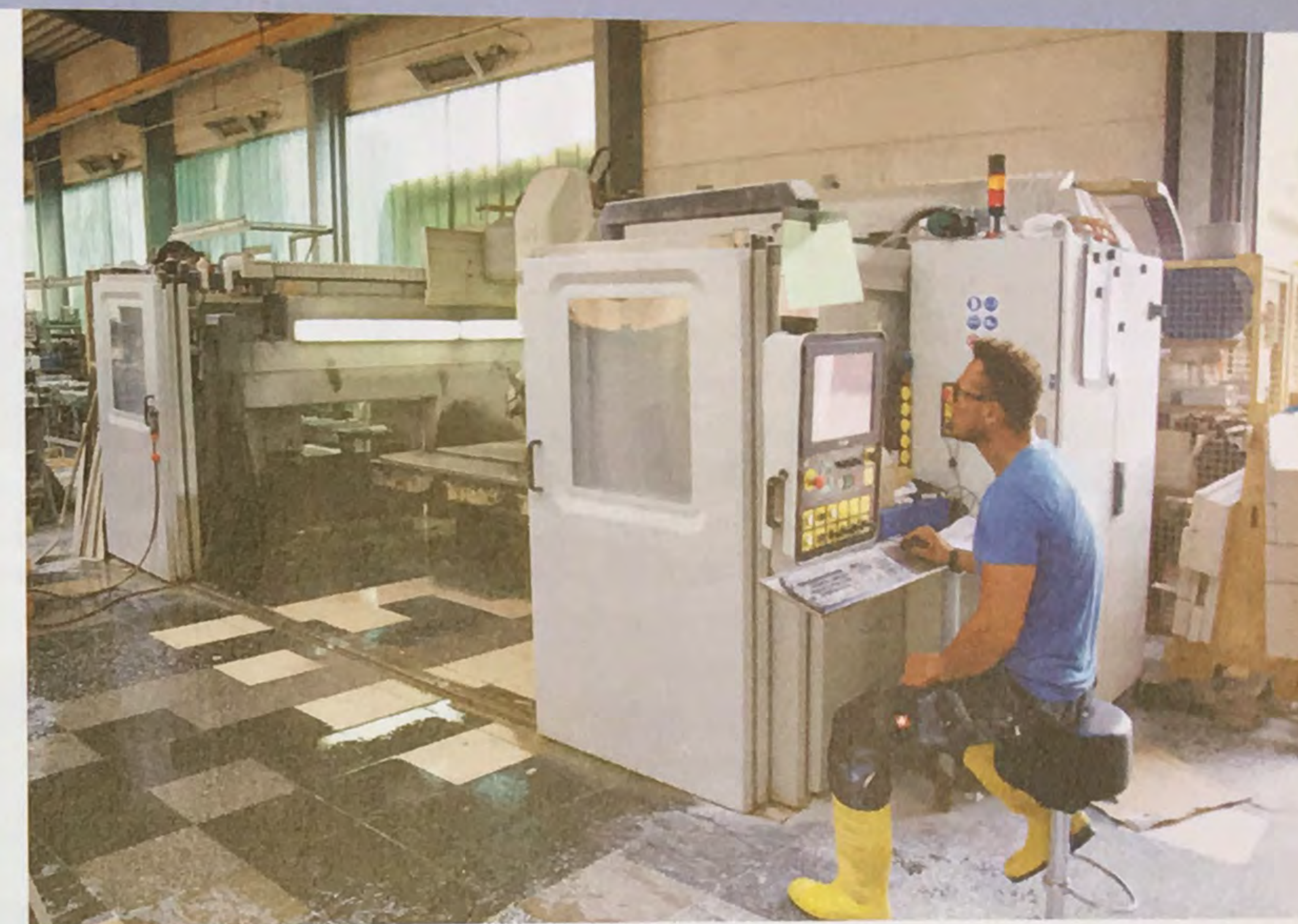
Hat sich kürzlich maschinentechnisch neu aufgestellt: Steinmetz Mirco Busch an der Maschine. Er programmiert die 5-Achs-Brückensäge Unika 5 von Denver mit integriertem Bearbeitungszentrum
